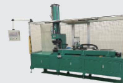
密闭阀叶片伺服多点无铆钉铆接专机
