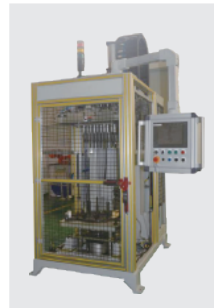
缸盖UC1169拧紧机设备
