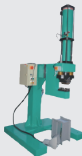
风阀边框加强筋 两点无铆钉连接设备
